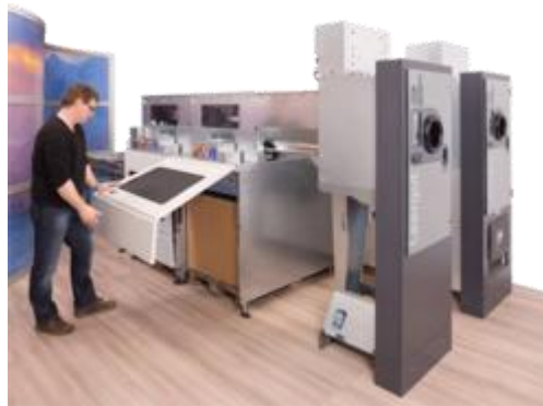
Figura 2: RVM da marca Repant com sistema de esteiras que destinam as embalagens para centrais de recolhimento moldadas conforme as necessidades do estabelecimento em que se instalará a máquina [21]
